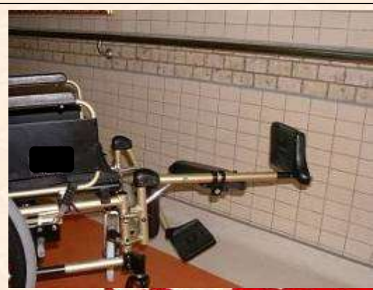
圖二十六： 輪椅-可拆卸式腳踏板
