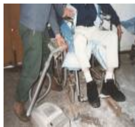
用吸塵機吸塑出坐墊及背墊的形狀
