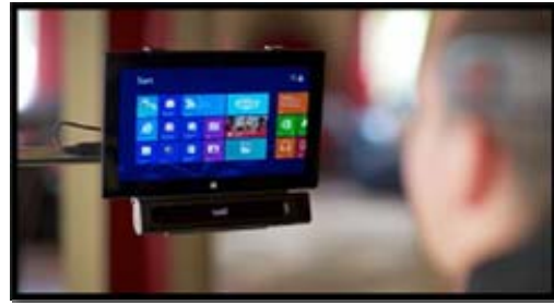
圖二、Tobii Eye tracking 系統
