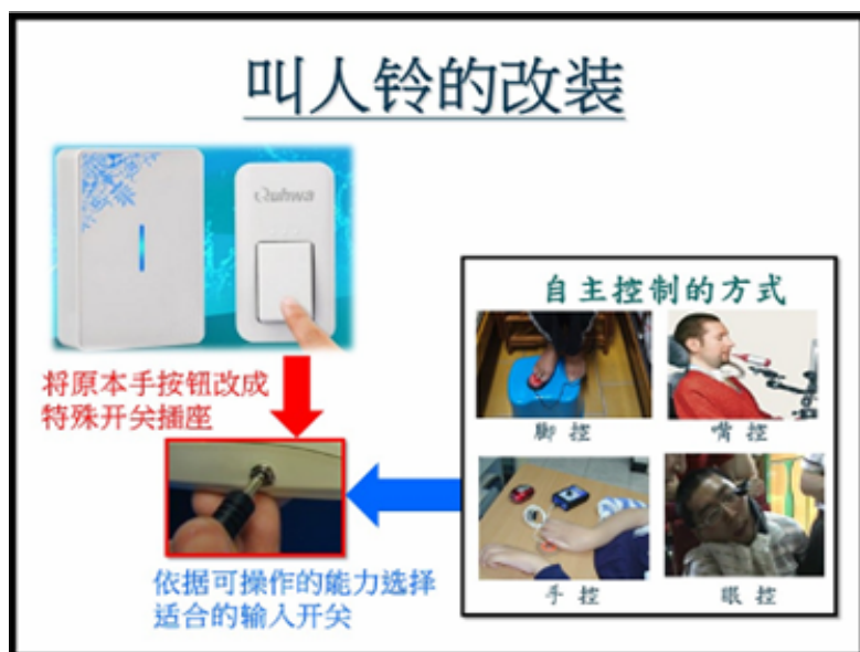
照片 2：利用无线门铃进行改装叫人铃
