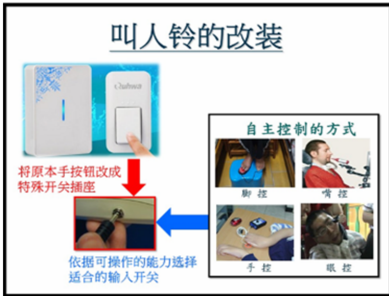
照片 2：利用无线门铃进行改装叫人铃
