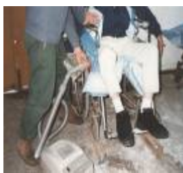
用吸尘器吸塑出坐垫及背垫的形状
