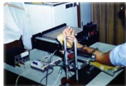
這項研究帶給我們很多新知識和新嘗試，首先是在量度壓力衣內壓力的方法上，工程師專家提供了量度儀器，在訪問時，大家都記起那長長的玻璃柱和薄而長的壓力感應器(sensor)及疤痕 extensimeter。Laplace Law 也是工程師當時告訴我們有關壓力的理論，如何計算壓力的比例亦更有系統地開展。
